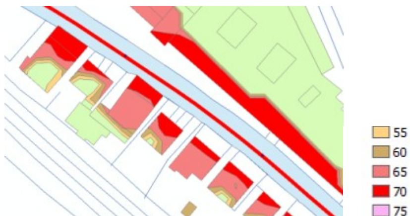
Figura 2.1.2 Livello di esposizione dei fabbricati pari a 70 dBA assunto eguale a quello sulla facciata più esposta
